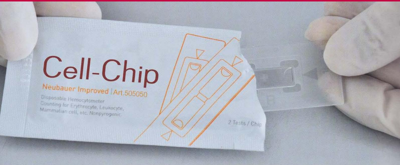
Die Einweg-Zählkammer Cell-Chip aus Kunststoff sieht genauso aus wie die bekannte Neubauer „improved“-Zählkammer. Die Zellen verteilen sich über 3 x 3 grosse Quadrate, jedes mit 1 mm Kantenlänge und mit einer Fläche von 1 mm<sup>2</sup>. Zählen Sie ihre Zellen wie gewohnt - Mit dem Cell-Chip injizieren Sie die Probe, gefärbt oder ungefärbt, in die gewünschte Zählkammer. Zwei getrennte Kammern ermöglichen zwei Zählungen pro Cell-Chip.
